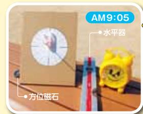
時計盤を北向きに、水平器を使って台が水平になるように置きます
